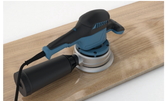
Lack-Zwischenschliff mit Exzenter-Schleifer
