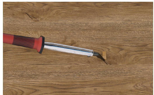
Schritt 2: Hartwachs mit dem LötKolben schmelzen
