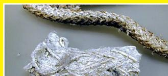
Cordoni per finestre, nastri isolanti in puro amianto nelle piastre di cottura
